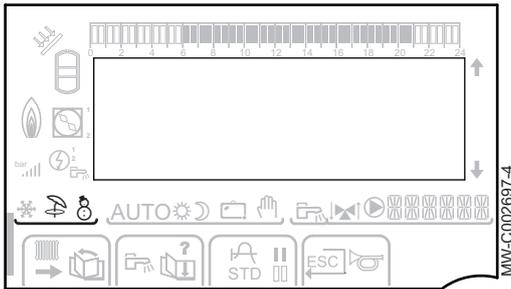
Fig.12 Indicateurs des modes de fonctionnement
