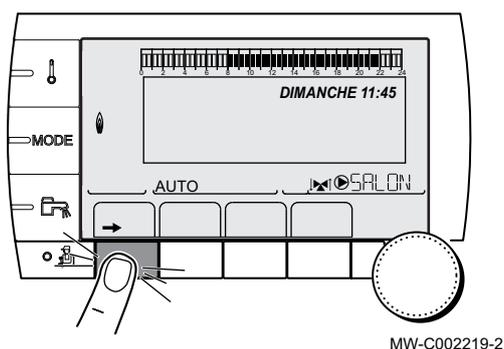
Fig.21 Accès au mode chauffage
