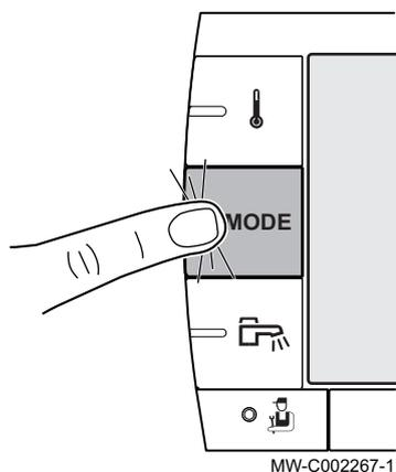
Fig.29 Forçage de la production d'eau chaude sanitaire
