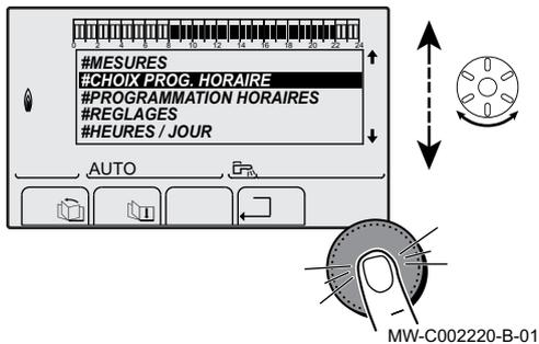
Fig.16 Sélection du paramètre
